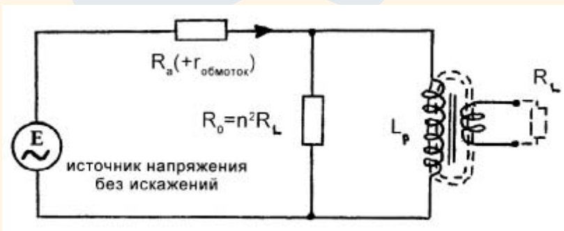
Рис.2 Упрощенная модель трансформатора, приведенная к первичной обмотке по Partridge. Заметьте, что L зависит от E , I , H , B , а также от \mu ! Поток \Phi = BA , так что I = c1\Phi/dt
